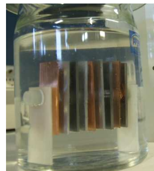
Figura 1: Disposición de los metales en el portamuestras para ensayos de corrosión. En las posiciones 1, 2 y 3 estudiaremos el comportamiento de Al, acero y cobre aislados, sin formar pares galvánicos. Entre las posiciones 4 y 5 formaremos un par galvánico Al-Cu; entre la 6 y 7 Al-acero y entre la 8 y la 9 formaremos el par Cu-Acero.
