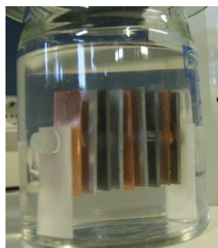
Figura 1: Disposición de los metales en el portamuestras para ensayos de corrosión. En las posiciones 1, 2 y 3 estudiaremos el comportamiento de Al, acero y cobre aislados, sin formar pares galvánicos. Entre las posiciones 4 y 5 formaremos un par galvánico Al-Cu; entre la 6 y 7 Al-acero y entre la 8 y la 9 formaremos el par Cu-Acero.
